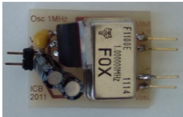
Figura 4.3. Placa Electrónica del Oscilador de 1 MHz, construida para realizar el prototipo del sistema.
