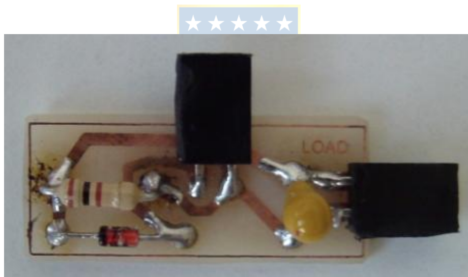
Figura 4.6. Circuito Electrónico del Rectificador de Media Onda y la Carga, implementado para el prototipo del sistema.
